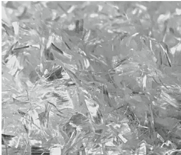
Mikrofasern, als Mono- bzw. Multifilamente ausgebildet
