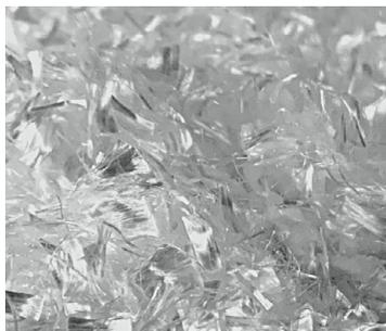
Microfibre, formate da mono- o multifilamenti
